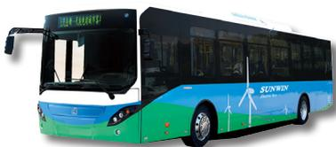
上海申沃纯电动公交客车采用轻量化全铝车身，续驶里程超过250公里，平均能耗小于1.0kwh/km，其运用的“六高一低”，高动力安全、高爬坡度、高品质锂电池、高可靠性驱动系统、高涉水能力、高车身寿命和低能耗，进一步体现公交优先、低碳环保的出行理念。
