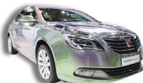
荣威950 Fuel Cell的动力电池采用了811所研制的锂电池，氢燃料电池系统则由上汽与大连新源合作开发，其装备了两个耐压能力为70MPa的储氢罐，储容量为4.18kg。两者配合可以使荣威950 FuelCell的匀速续航里程达到400km。
