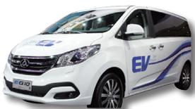
上汽大通EG10是国内首款纯电动MPV，拥有“超强动力、超凡安全、超低能耗、超然绿色”四大亮点。该车型采用150kW大功率永磁同步电机，峰值扭矩达到800Nm，最高车速达到150km/h，综合工况续驶里程超过150km。
